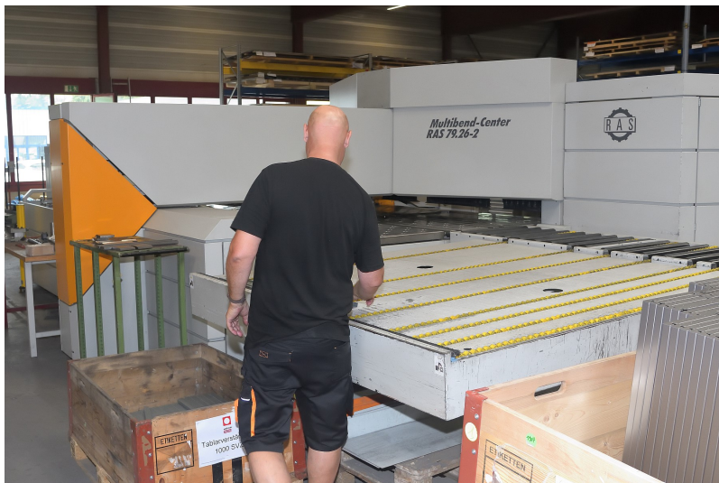
Ein Schwenkbiegecenter bietet Gestaltungsflexibilität für komplexe und hochentwickelte Designteile.
