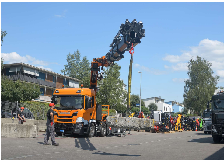
Vor der Auslieferung eines fertigen Kranwagens steht ein umfassendes Testprogramm – hier mit einem Beton-Prüfgewicht.
